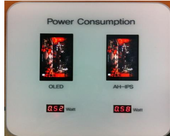
Mobile LCD 소모 전류 측정 시스템
