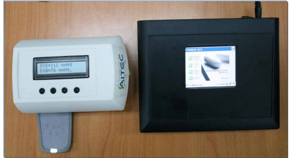
ex. 무선통신을 이용한 혈압측정 데이터 수집장치
